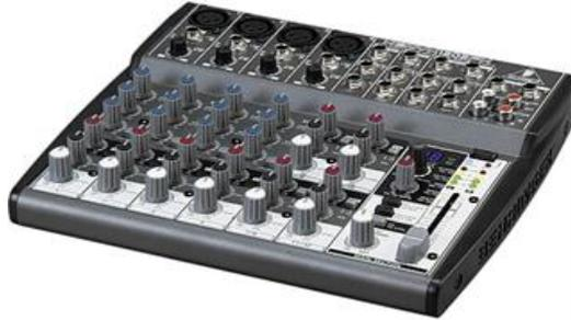
**Ilustración 12:** Mezclador de audio de 12 canales marca Behringer<sup>42</sup>.
