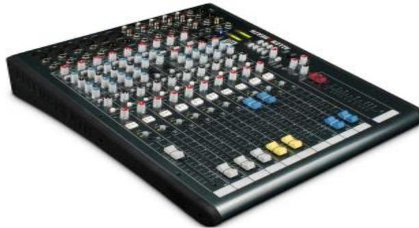
**Ilustración 14:** Mezclador de audio de 14 canales versión para radio<sup>46</sup>.
